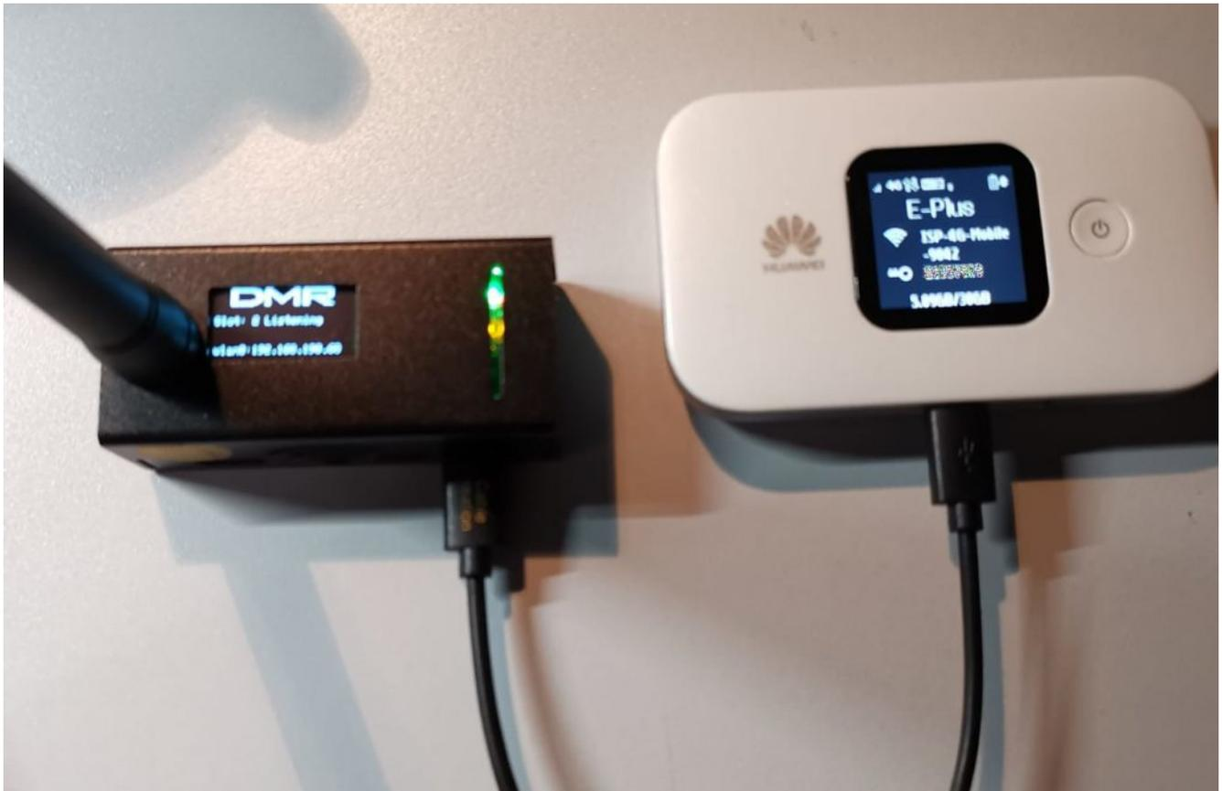
Hier ist der MMDVM (links) mit einem Huawei Router verbunden, der sogar das Modem mit Strom versorgen kann und so zeitgleich als LAN Netzwerk, also ohne WiFi Nutzung, verbunden ist.
